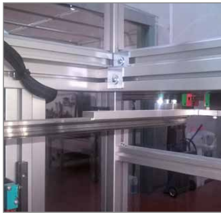
Guide lineari con pattini a ricircolo di sfere per precisioni centesimali
