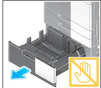
**2** Cargue papel en el lado derecho de la bandeja de la **LCT (integrada)** de modo que el lado que se va a imprimir esté boca arriba.
